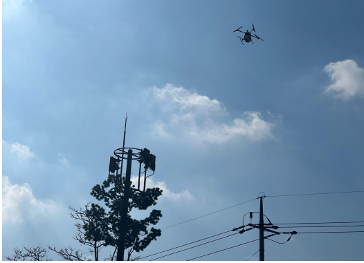
그림 7. UASAM을 이용한 기지국 안테나 패턴 측정 Fig. 7. Base Station Antenna Pattern Measurement using UASAM
