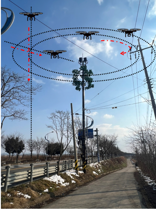
그림 1. 드론 기지국 안테나 패턴 측정 방법 Fig. 1. Drone Base Station Antenna Pattern Measurement Method
